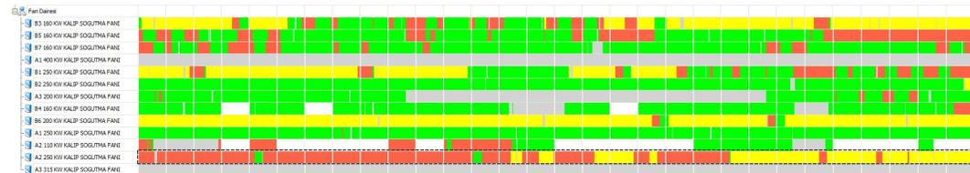
Am 22. Oktober 2015, nach der vom ACS-Wartungsteam durchgeführten Lagerwartung, ist der Parameter "Lagerausfall" unter den Schwellenwert gefallen. Der Parameter "Loses Fundament/Komponente" hat sich jedoch erhöht und MCM hat am selben Tag einen Alarm ausgelöst. Während des Gesprächs mit dem Wartungsteam wurden die erforderlichen Kontrollen selbst durchgeführt. Nach den Wartungsarbeiten am 10. November 2015 ist der Parameter "Loses Fundament" unter den Schwellenwert gefallen.
