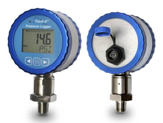
Der Logger ist in einem robusten Gehäuse aus eloxiertem Aluminium und Edelstahl eingebaut und hat einen Standard 1/4"NPT Prozessanschluss (1 /2 " NPT für die Bereiche 400bar und 1000bar). Die austauschbare interne Lithium -Batterie hat eine Lebensdauer von bis zu 3 Jahren. Zu dem Datenlogger gehört die kostenlose Track-It Software zum Auslesen, Auswerten und Exportieren der Daten ins ASCII Format.
