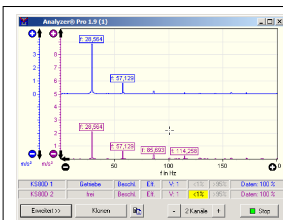
Bis zu 4 Signale gleichzeitig analysieren, Phasenanzeige zuschaltbar.
