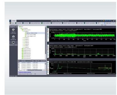
Die Software dient der Überwachung des Maschinenzustandes in Echtzeit, und kann Fehler der Maschine im Voraus erkennen und ungeplante Ausfallzeiten vermeiden.
