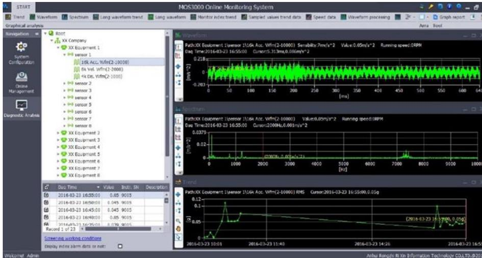
Mehr als 20 verschiedene Auswertungsdiagramme stehen dem Schwingungsanalytiker zur Verfügung: Rohsignale, Spektrum, Multi-Spektrum, Hüllkurvenspektrum, Cepstrum und viele weitere.
