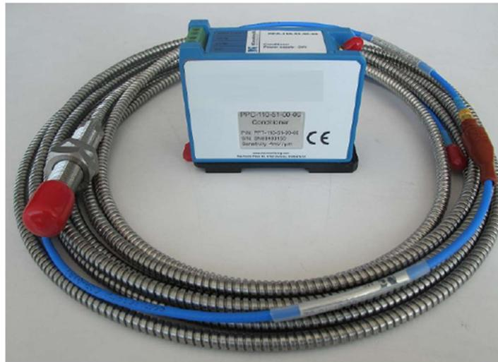
Die Wirbelstrom-Wegsensor-Messkette PPT wird für die berührungslose Messung von Wellenschwingungen und -positionen eingesetzt. Jede Messkette besteht aus einem Sensor PPS, einem Verlängerungskabel PPE und einem Messwandler PPC.
