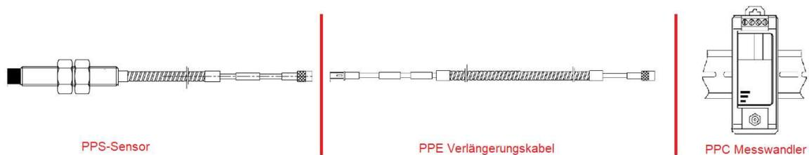
Die Wegsensoren der Serie PPT sind so konzipiert, dass sie dem Standard API 670 entsprechen. Der Spannungsausgang ist direkt proportional zum gemessenen Abstand zwischen dem metallischen Messobjekt und der Sensorfläche.
