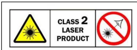
Diodenlaser max. Ausgangsleistung: < 1mWatt
